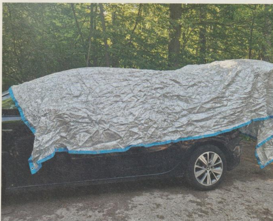
Spezielle UV-Schattennetze aus Alugewebe reflektieren einen Großteil der Sonnenstrahlen und verringern so das Aufheizen des Autos.
